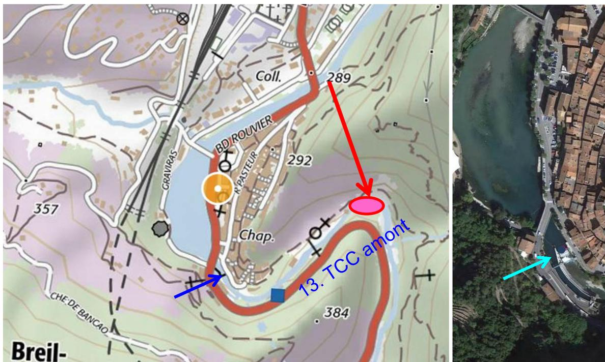
**Figure 5:** Positionnement de la station 13 (rond rose) et des évacuateurs de crues utilisés comme passage de la Roya pendant la durée des travaux (flèche rouge) par rapport au barrage (flèches bleues).
